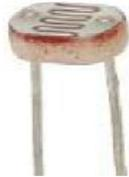
Gambar 3. Bentuk Sensor LDR
