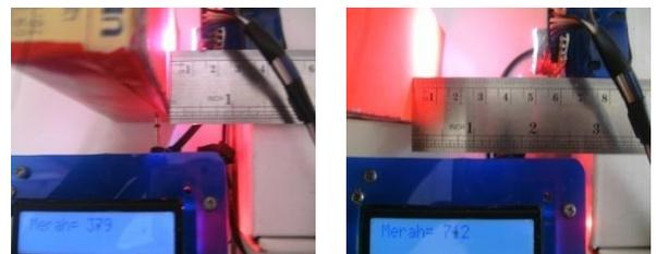
Gambar 12. Pengujian sensor warna terhadap jarak (a). Jarak 1 cm. (b). Jarak 5 cm.
